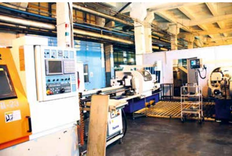
Станки с программным управлением на автоматнo-зубофрезерном участке
