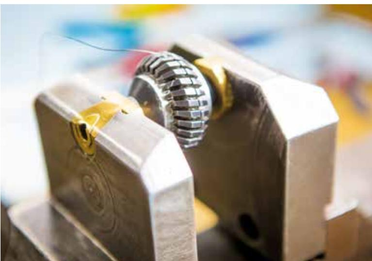
*Приспособление для сшивки амортизаторов*
