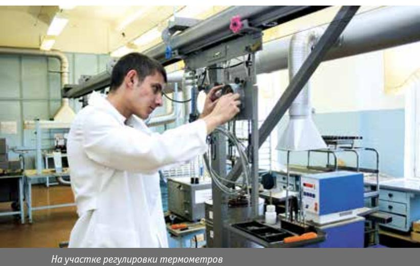
На участке регулировки термометров
