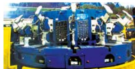
*Литьевая машина для производства полимернотекстильной обуви с подошвой из термопластичных материалов совместного производства Тираспольского завода «Точлитмаш» и итальянской фирмы «Otto Gale»*
