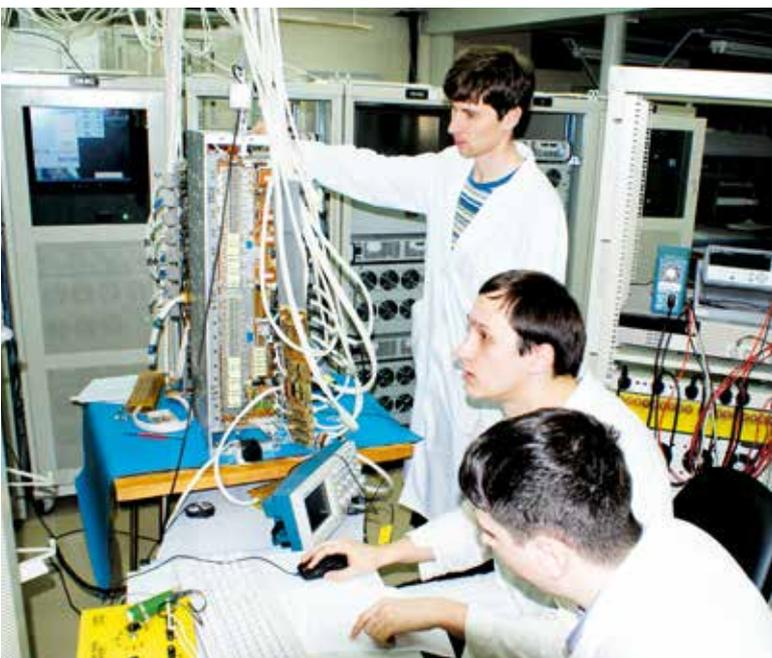
Отработка энергопреобразующей аппаратуры для нового поколения космических аппаратов
