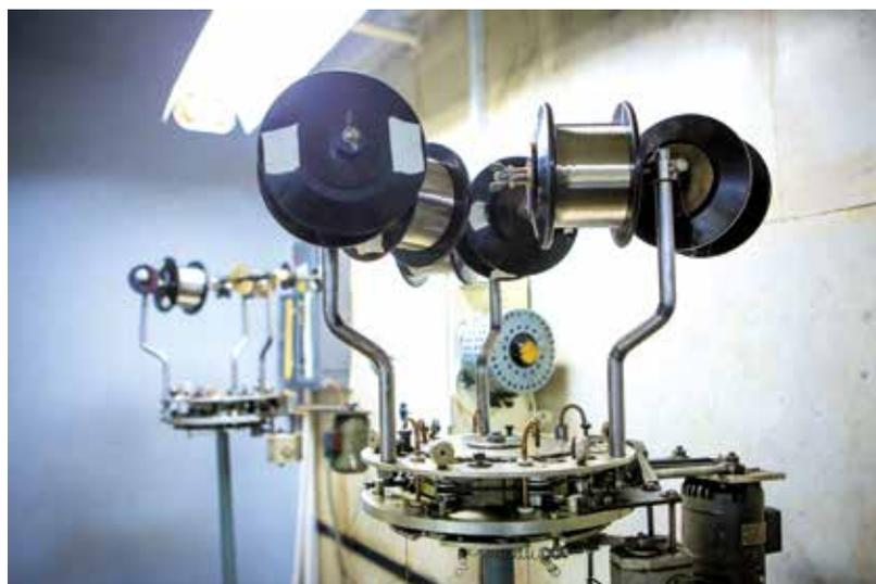
*Станок для навивки спиралей амортизаторов*
