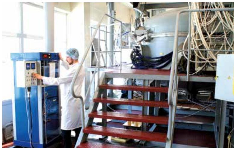
Вакуумная камера для имитации условий открытого космического пространства
