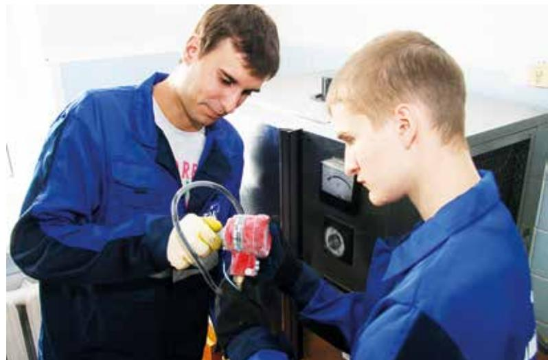
Настройка датчика газосигнализатора ГСМ
