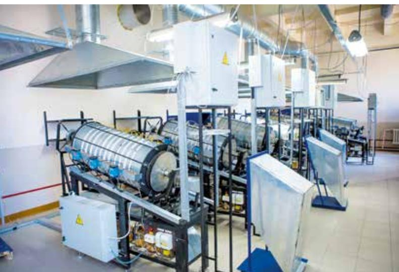
Ростовые горизонтальные печи по производству монокристаллических материалов на основе (Zn, Be, P2)
