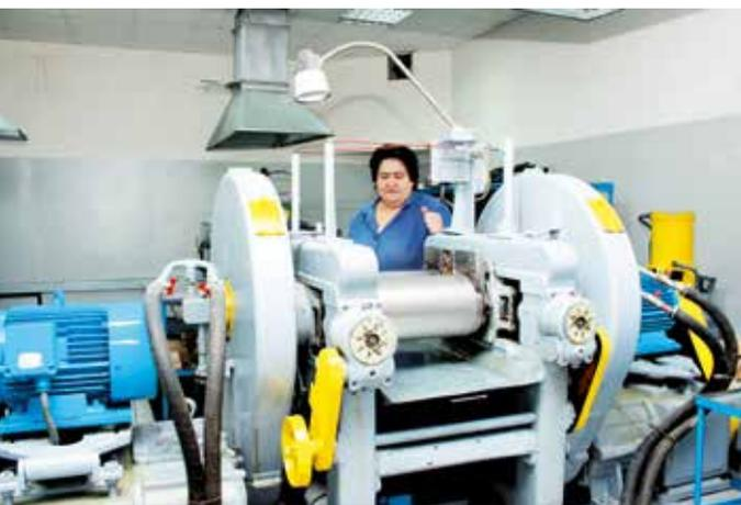
Лаборант физико-механических испытаний на лабораторных вальцах проводит окрашивание резиновых смесей
