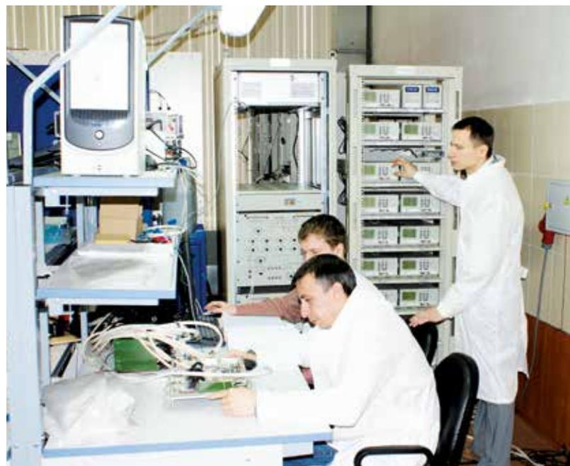
Отработка программного обеспечения для комплекса управления системы электроснабжения малого космического аппарата
