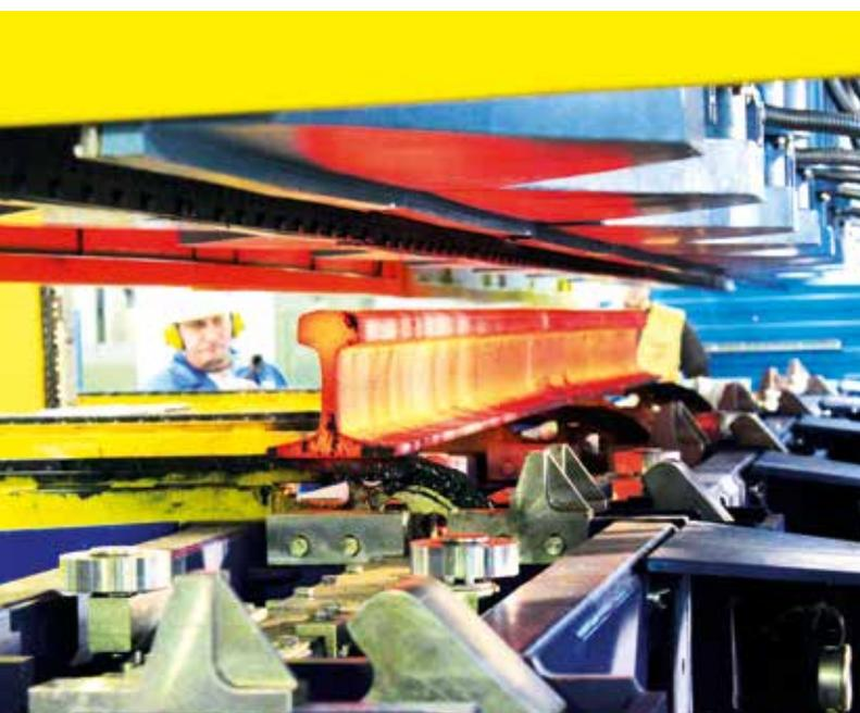
Железнодорожный рельс в процессе термообработки по технологии НПП «ТЭК»
