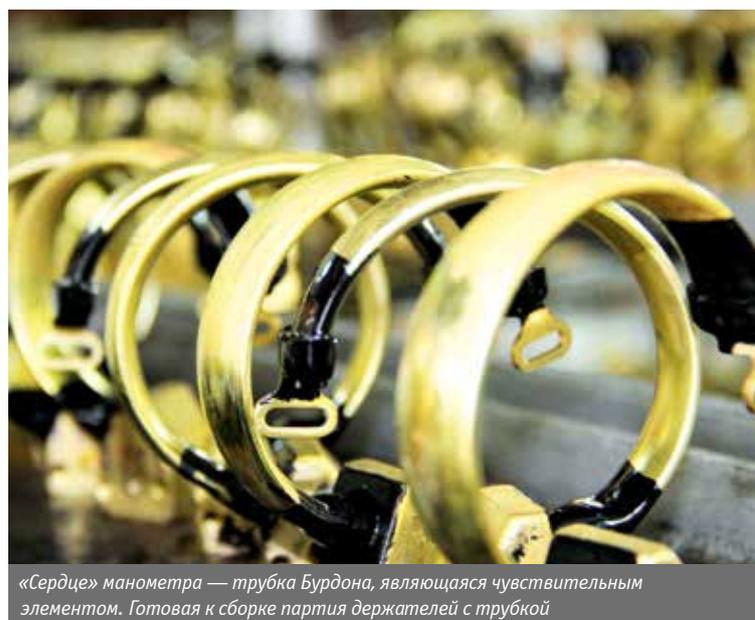
«Сердце» манометра — трубка Бурдона, являющаяся чувствительным элементом. Готовая к сборке партия держателей с трубкой
