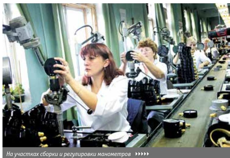
На участках сборки и регулировки манометров ▶▶▶▶
