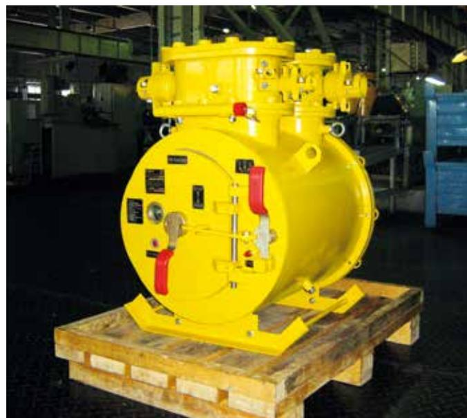
Пускатель взрывозащищенный ЗПВР125-400, 2012 г.
