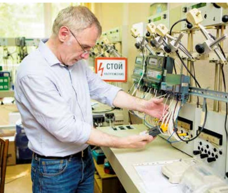
Лаборатория по проверке счетчиков электроэнергии
