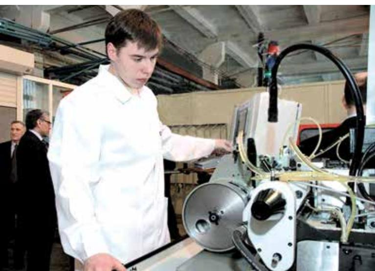
Производство деталей механизма манометра на новом оборудовании с программным управлением
