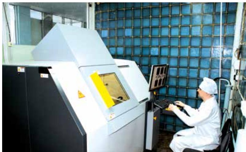
Установка рентгеновского неразрушающего контроля качества монтажа ЭРИ, печатных плат, узлов
