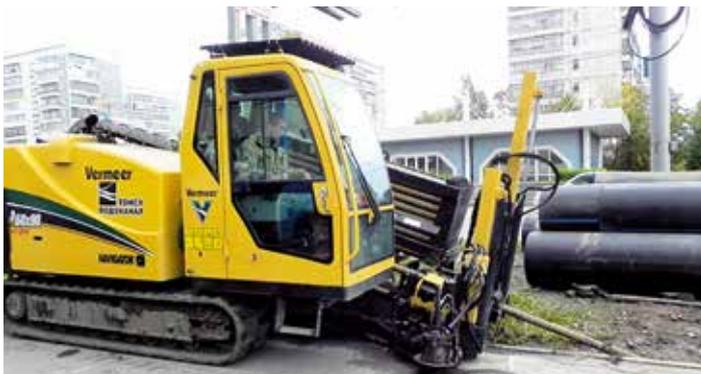
Установка горизонтального направленного бурения
