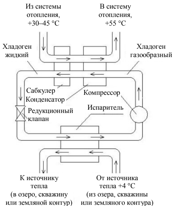
Рис. 3. Принцип действия теплового насоса
