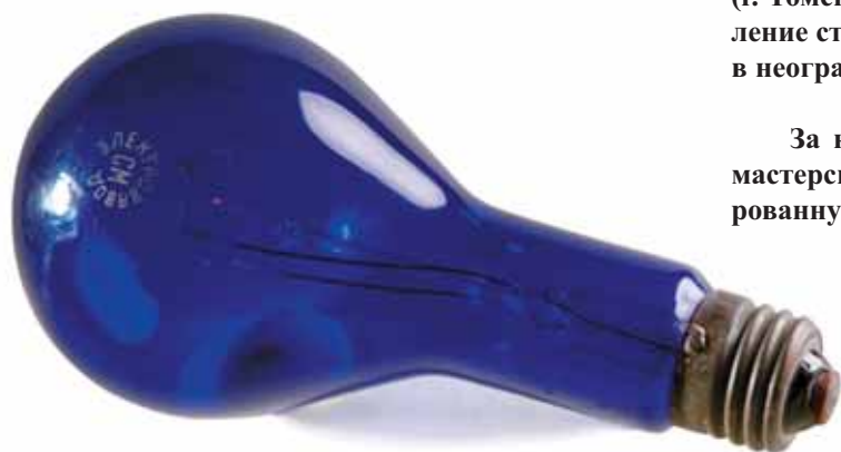
Оразец лампочки военных лет с синим баллоном — для светомаскировки. На цоколе указано рабочее напряжение 120 вольт, что было характерно для довоенных электрических сетей.
